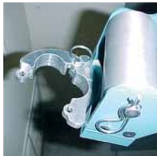
Adaptadores partidos para facilitar el desmontaje
